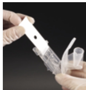
Coloque un nuevo filtro en el portaobjetos del microscopio.
