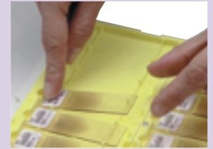
Fácil extracción del portaobjetos presionando hacia abajo en un extremo y levantarlo del otro.
