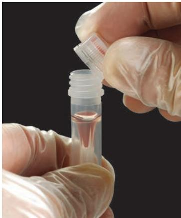
Visser le bouchon inviolable sur le tube jusqu'à ce que la bague de verrouillage clique sur le col dentelé du tube.
